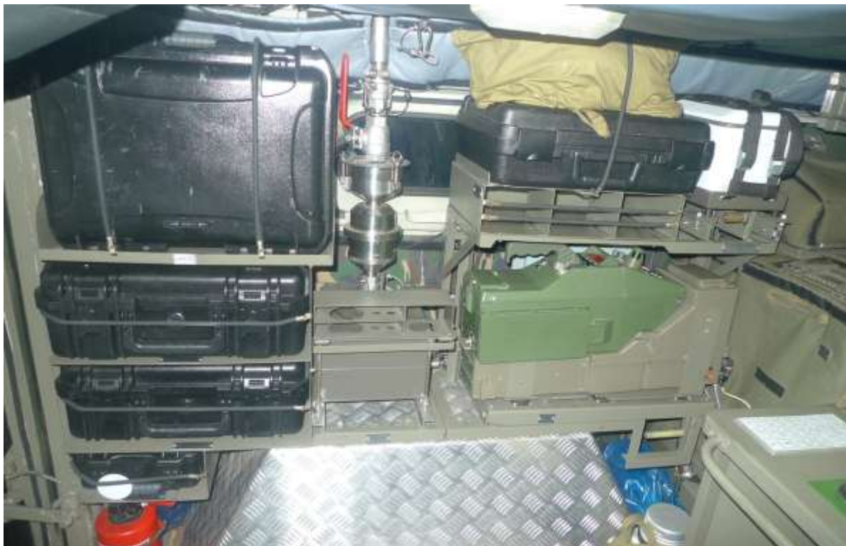
Вид на задний борт машины РХМ-8 (Устройство выброса знаков ограждения):
