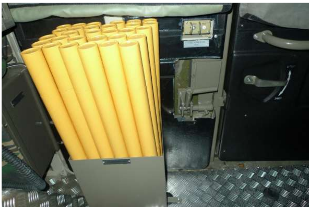
Вид на задний борт машины РХМ-8 (Устройство выброса знаков ограждения):
