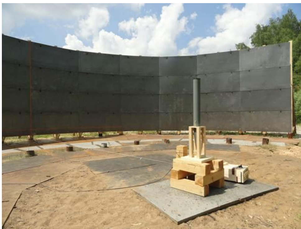
Рисунок 7 – Отделяемая осколочно-фугасная ГЧ на стенде подрыва
