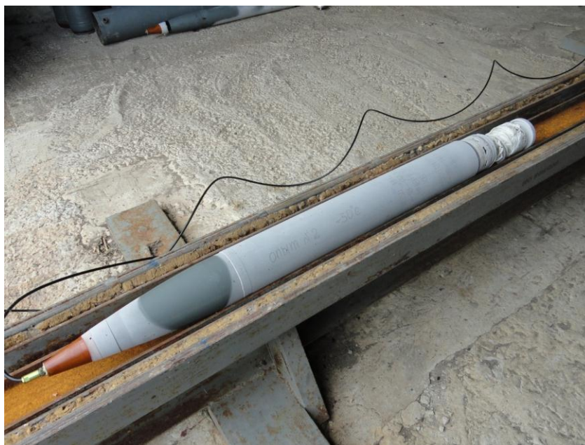
Рисунок 8 - Отделяемая осколочно-фугасная ГЧ на стенде отделения
