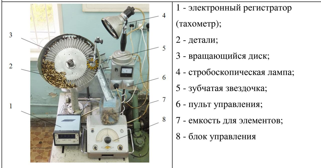
По результатам проведенных экспериментов с помощью стандартного пакета *CurvExpert 1.3* была найдена аппроксимирующая функция, отражающая зависимость коэффициента выдачи БЗУ от окружной скорости.
