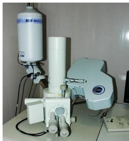
Электронный микроскоп JSM-6390
