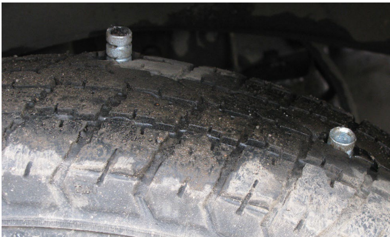
Рисунок 8 – шипы изделия «Лиана-6000» в покрышке колеса автомобиля, который совершил наезд на изделие «Лиана-6000»
