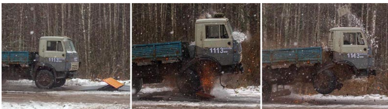
Рис. 5 – Испытания поста остановки колесного автотранспорта «ПОКАТ-5000У»
