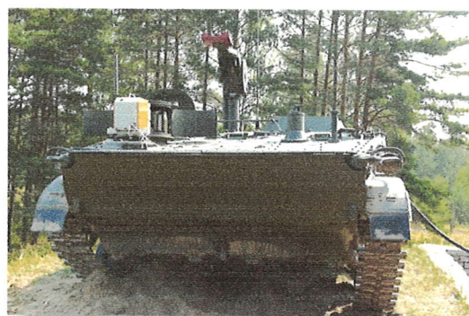
Проверка модернизированной БМ 9П157 с помощью доработанной КПМ 9В945
