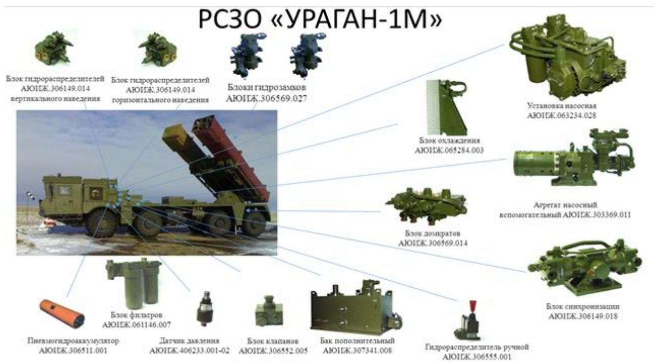
Рис. 1 – Перечень приборов системы следящих приводов наведения и поддомкрачивания.
